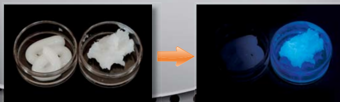
写真左がASKグリース、右がASKグリースUVです。ブラックライトを照射することでグリースの漏れやグリース添付状況が確認出来ます。
